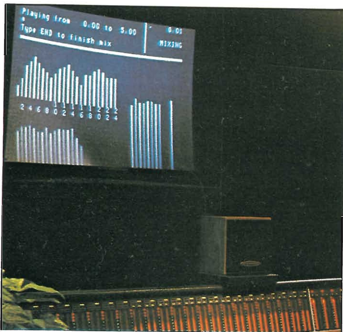
Visualizzazioni del livello VCA e dello stato degli attenuatori. I livelli VCA sono visualizzati sugli strumenti oppure sul monitor video. Lo stato degli attenuatori è indicato dai LED sul pannello di ciascun attenuatore.
