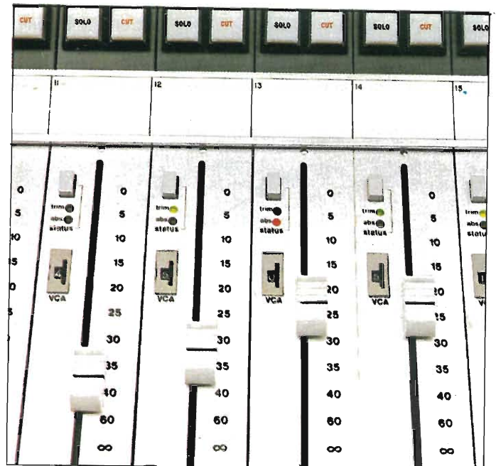
Visualizzazioni del livello VCA e dello stato degli attenuatori. I livelli VCA sono visualizzati sugli strumenti oppure sul monitor video. Lo stato degli attenuatori è indicato dai LED sul pannello di ciascun attenuatore.
